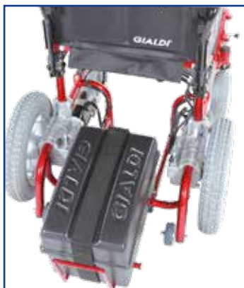
Batteria estraibile a carrello
