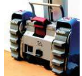
Doppio blocco, elettrico e meccanico, dell'aggancio timone al corpo motore
